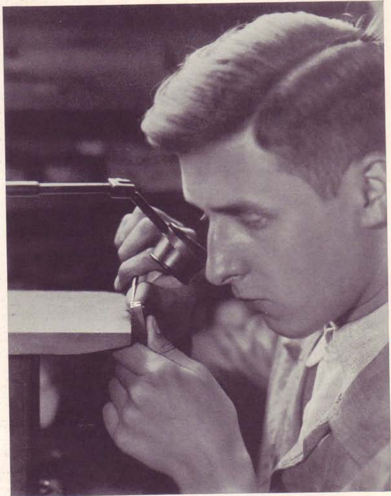
Schneiden des Stahlstempels mit der Hand
